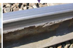
Schienenoberflächenschädigung Gerade
